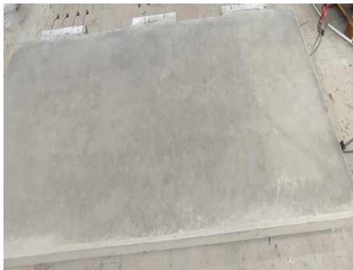
Ciemniejsza powierzchnia zacierana prefabrykatu
